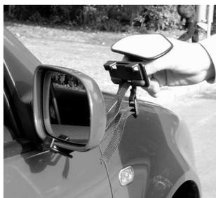
2. Enclencher le support en plastique inférieur au pied du rétroviseur.
