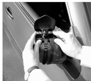
3. Faire glisser le système de maintien du haut du rétroviseur au dessus du bord supérieur du rétroviseur. Lors du premier montage ajuster la longueur du système en caoutchouc, afin d'assurer un maintien parfait.
