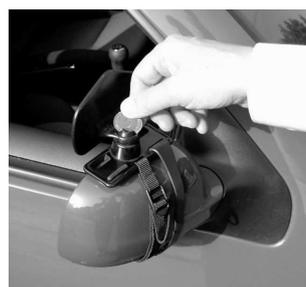
6. Vous pouvez avec une pièce de monnaie desserrer la visse de maintien du joint articulé, afin de régler le rétroviseur dans la direction optimale désirée. Après revisser.
